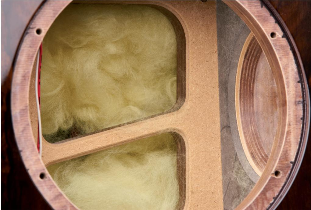
*Ein Blick in das Gehäuse aus Panzerholz, das hart genug ist, um Gewinde hinein zu schneiden. Zieht man eine Schraube zu fest an, reißt diese, das Gewinde aber gibt nicht nach, berichtete Rainer Weber. Für die Dämpfung verwendet er Angel Hair*
