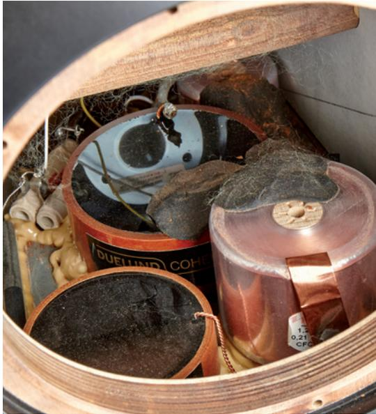
*Ein Blick auf die Weichenbauteile zeigt, dass hier nicht gekleckert, sondern geklotzt wurde. Von Duelund kommen nur die teureren PIO-Cast Typen zum Einsatz, die Mundorf Spulen im Parallelzweig haben ein beträchtliches Kaliber. Im Zusammenhang mit dem hohen handwerklichen Aufwand bei der Schreinerarbeit wird auch klar, dass dies alles nicht zum Schnäppchenpreis zu haben ist*
