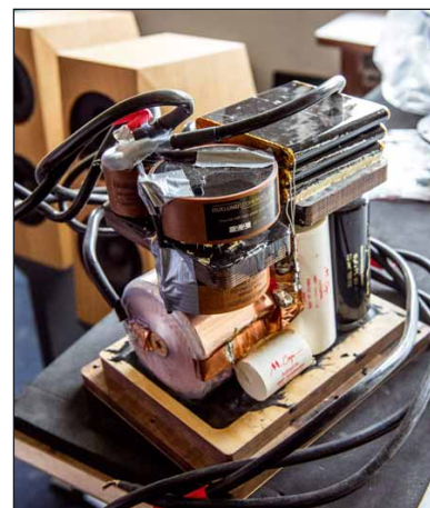
Nicht die aus der Chiara, aber die Idee dahinter wird klar: Frequenzweiche, Kaiser-Style
